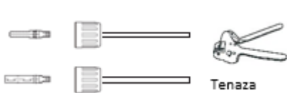
Figura 3.20 Enganche la clavija de contacto al cable
