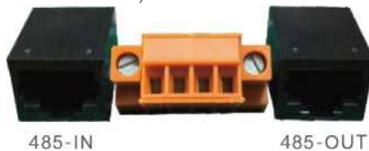
▲ Figura 5.24 Puerto RJ45 y placa de terminales
