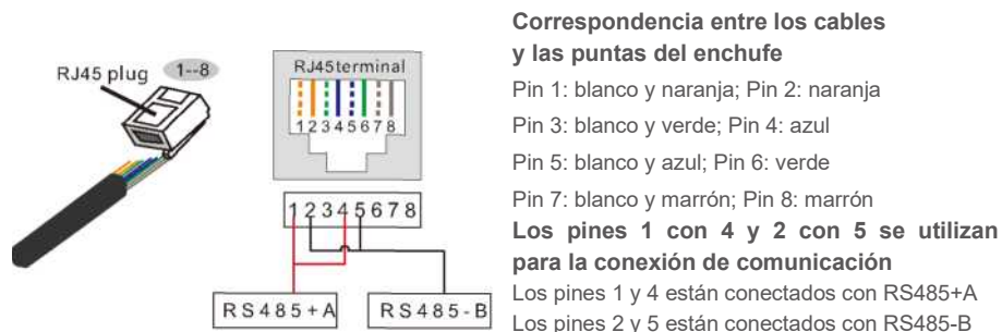
▲ Figura 5.29 Pele la capa de aislamiento y conecte al enchufe RJ45
